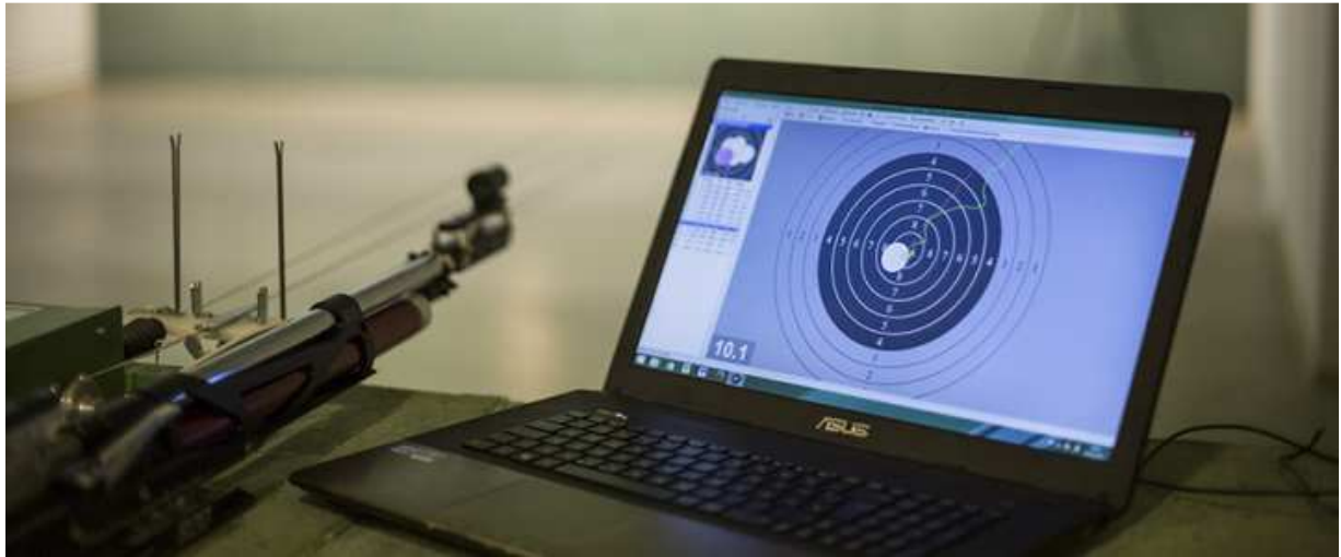
Scatt-Anlage: Aufsatz am Gewehr mit Datenübertragung auf einen Computer
